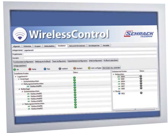
Jede im Netzwerk angemeldete Leuchte erscheint übersichtlich mit ihrem aktuellen Status in einer Liste.
