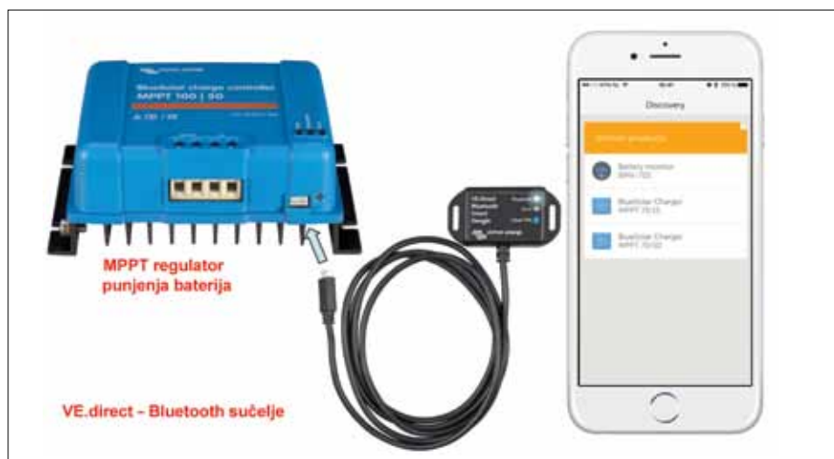
Slika 3.: Mogućnost komunikacije pametnog telefona s regulatorom punjenja.
