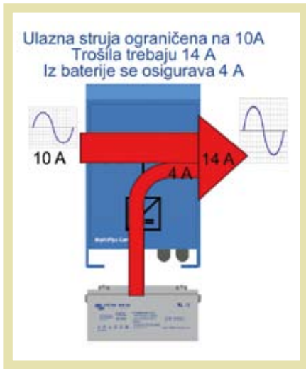
Slika 5. PowerAssist način rada bidirekcijskog pretvarača
