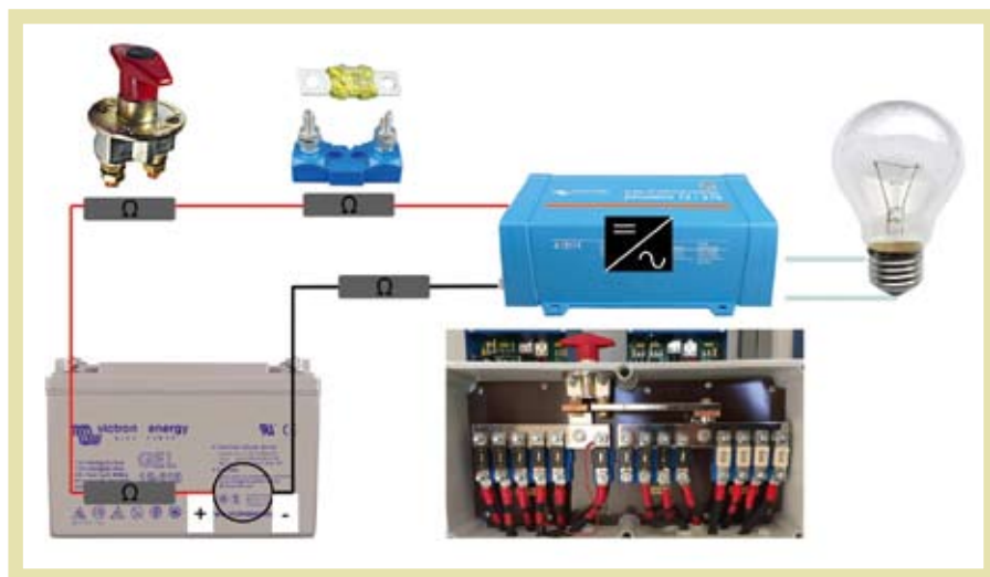
Slika 11. Elementi u instalaciji koji sudjeluju u stvaranju valovitosti napona na ulazu izmjenjivača
