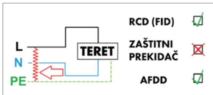
Slika 5. Curenje struje može uočiti RCD sklopka i AFDD
