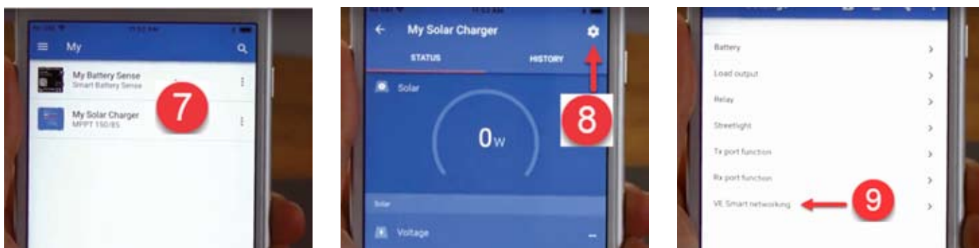
Slika 7. Pridruživanje MPPT solarnog regulatora SBS temperaturnom osjetniku
