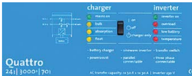
Slika 16. Prednja ploča jednog bidirekcijskog izmjenjivača iz serije Quattro . Vidljivo su napisani svi bitni podaci.
