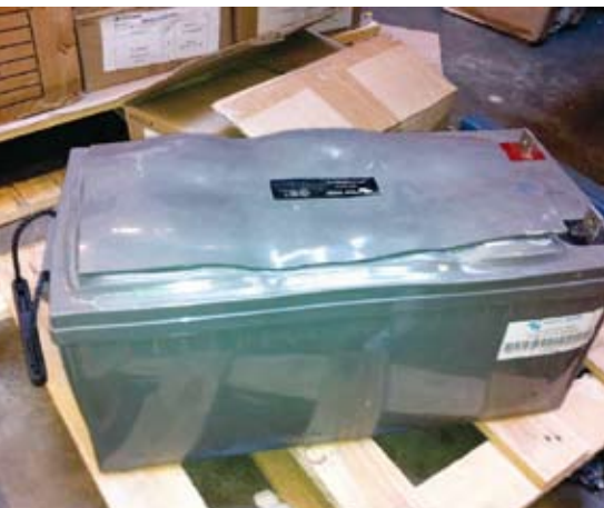
Slika 4. Termički pobjeg zatvorenih baterija
