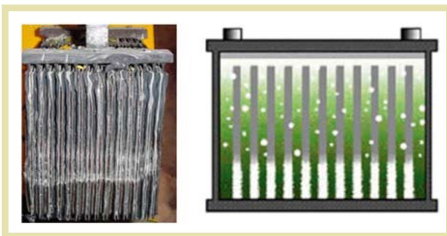
Slika 3. Stratifikacija ploča baterije
