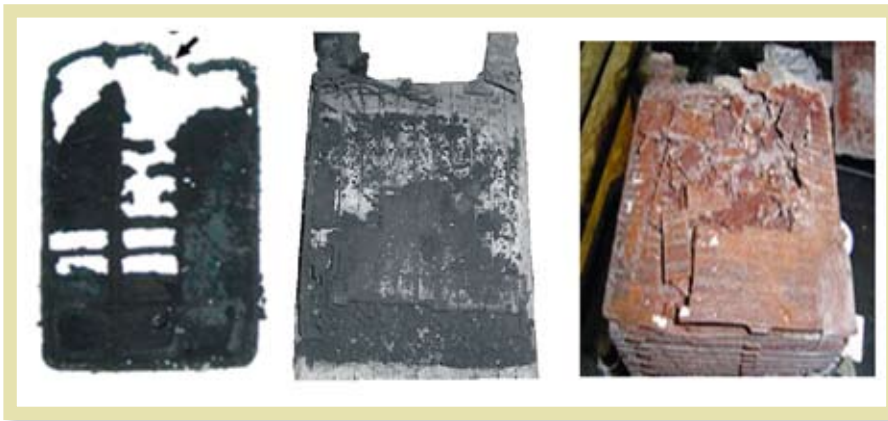
Slika 2. Korozija ploča baterije
