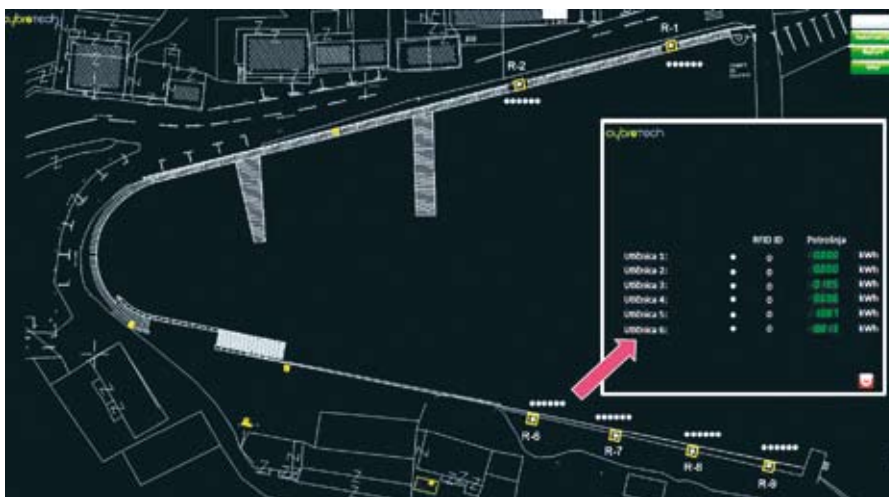
Slika 12. Prikaz nadzora priključnih ormarića luke Rogač na otoku Šolti
