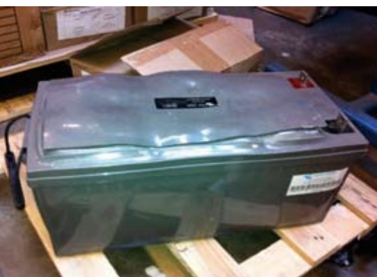
Slika 2. Napuhnuta, neispravna baterija kao posljedica punjenja previsokim naponom
