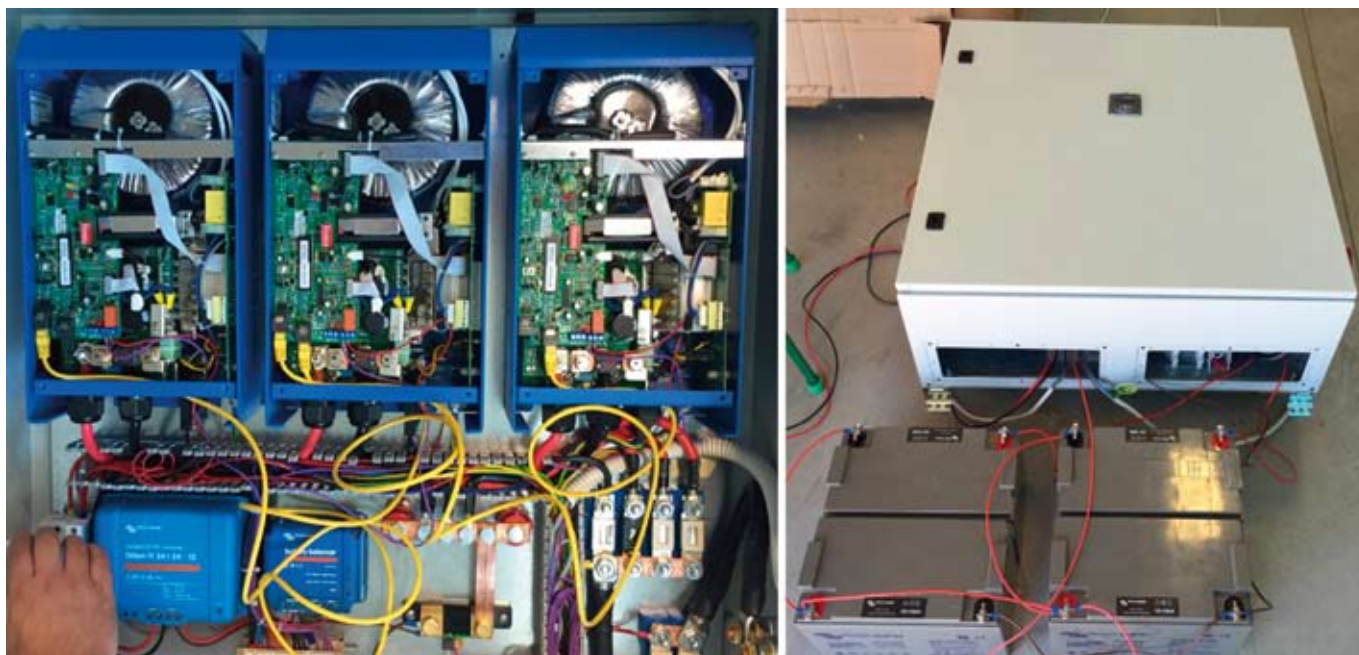
Slika 8. Ispitivanje funkcionalnosti tri autonomna izmjenjivača
