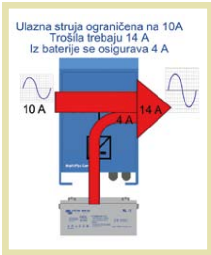
Slika 5. PowerAssist način rada bidirekcijskog pretvarača
