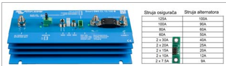
Slika 4. BMS CL 12/100 uređaj s nadzor i zaštitu LFP baterije s tablicom za izbor osigurača
