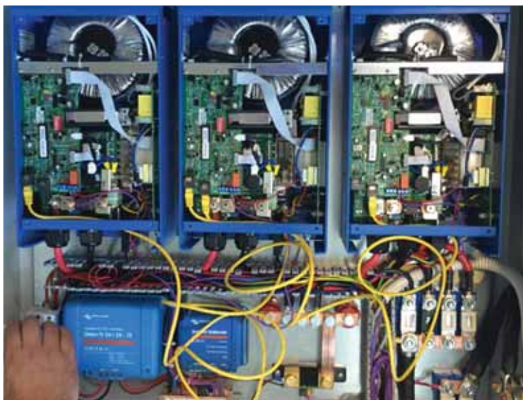
Slika 7 Ispitivanje funkcionalnosti tri autonomna izmjenjivača.
