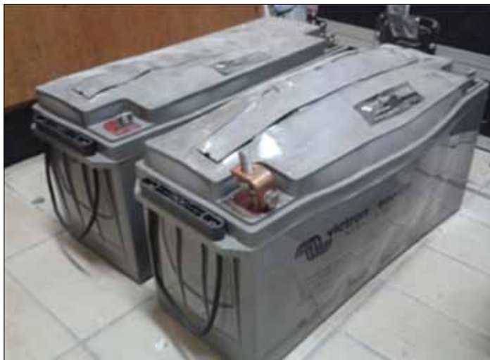
Slika 5.: Termički pobjeg zatvorenih baterija. Posuda baterije je deformirana zbog pregrijavanja i unutrašnjeg tlaka plinova.
