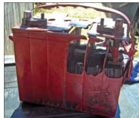
Slika 6.: Olovne baterije nakon eksplozije.
