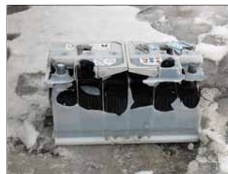
Slika 5.: Termički pobjeg zatvorenih baterija. Posuda baterije je deformirana zbog pregrijavanja i unutrašnjeg tlaka plinova.
