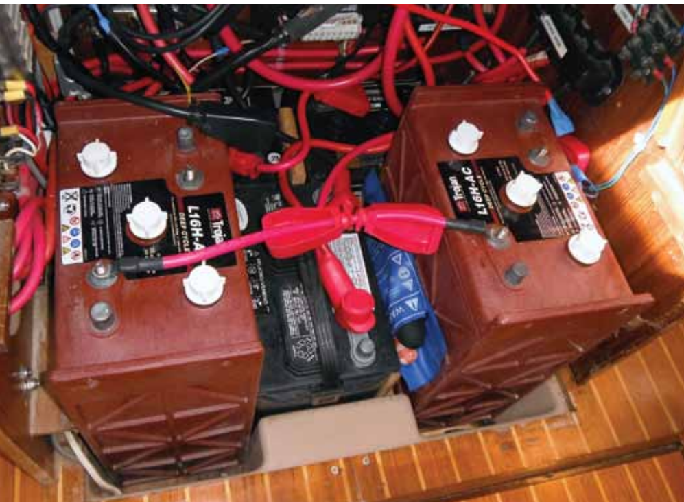
Slika 9. Uređaj za balansiranje napona u sustavu s dvije baterije.
