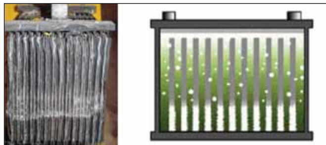
Slika 4.: Stratifikacija ploča baterije
