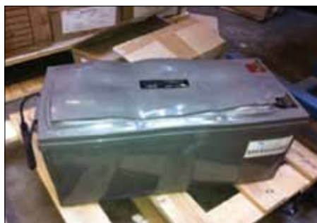
Pregrijana baterija može nabubriti zbog razvoja i širenja plinova u kućištu.
