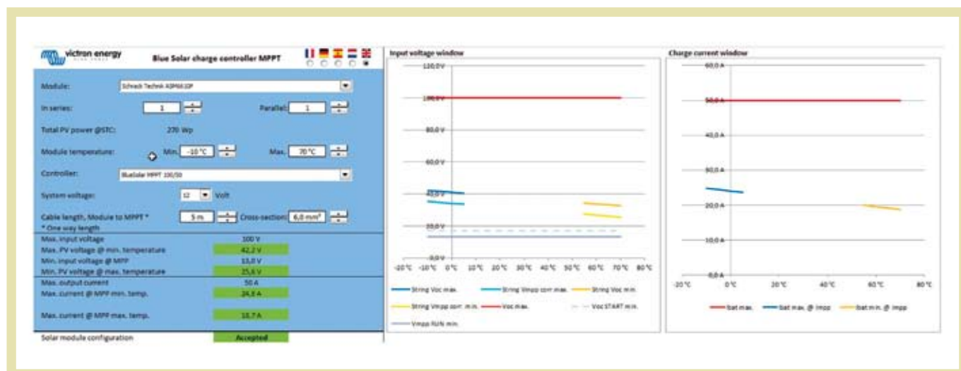
Slika 6. Provjera MPPT punjača 100/50 za 1 FN modul 270 Wp i 12 V bateriju
